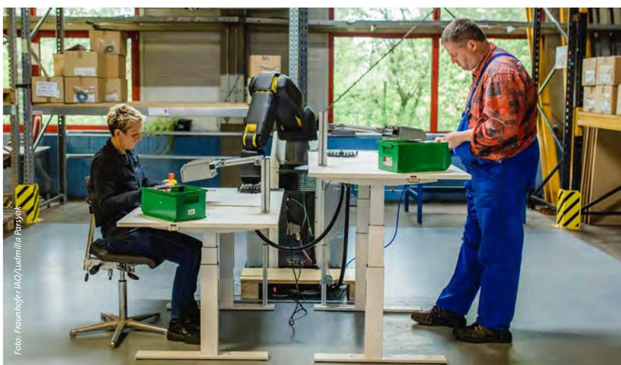
Der Roboterarm passt sich unterschiedlichen Tischhöhen an
